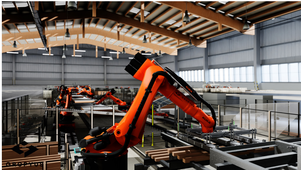
Abbildung 5.14: Fertigungsanlage für seriellen Wohnungsbau
