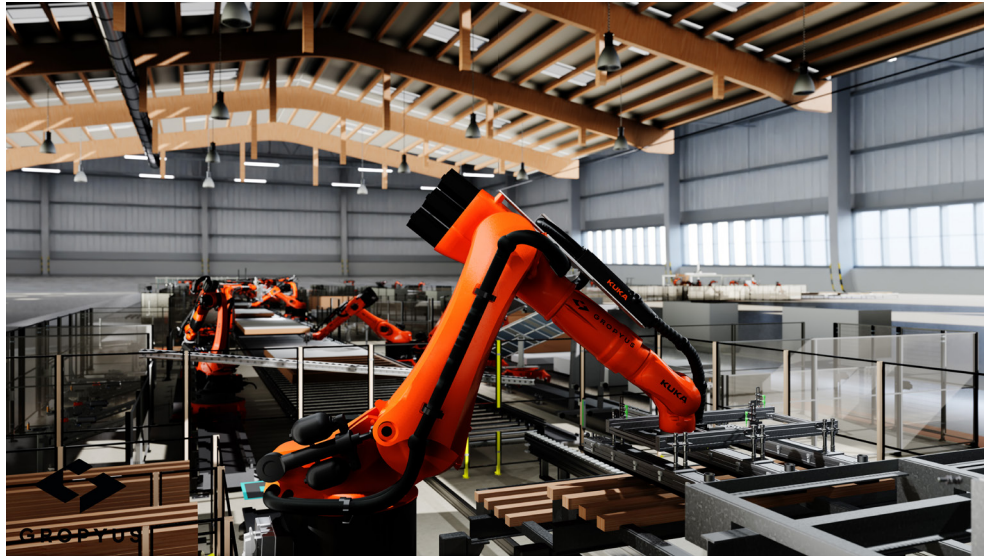
Abbildung 5.14: Fertigungsanlage für seriellen Wohnungsbau
